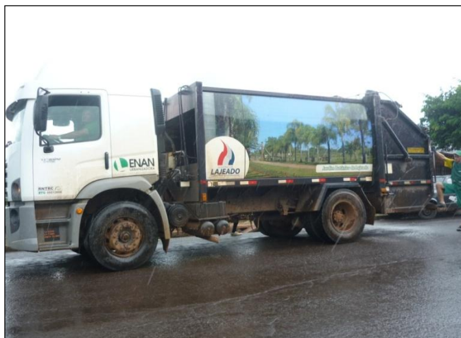
Figura 95: Caminhão Compactador que Realiza a Coleta Domiciliar Convencional.
