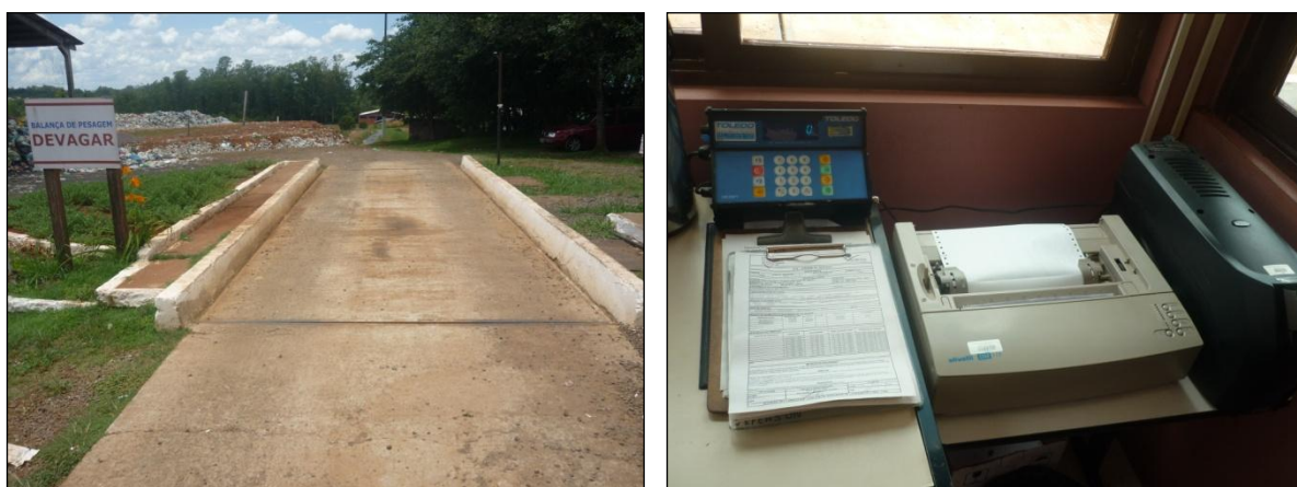
Figura 99: Balança Rodoviária e Sala de Registro das Pesagens.
