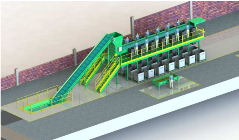
Figura 9: Modelo de Central de Triagem com esteras elevadas;
