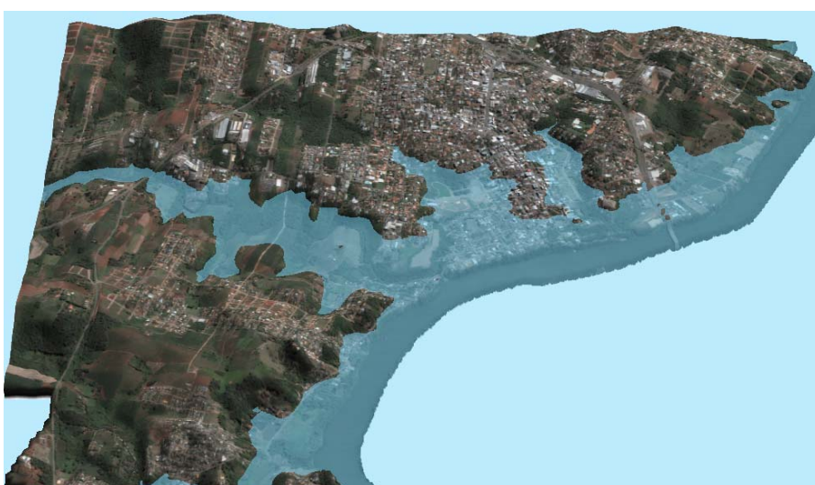
Figura 39 - f - Cota de inundação de 28 metros
