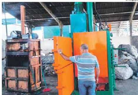
FACILIDADE: equipamento vai permitir compactação dos resíduos para reciclagem
