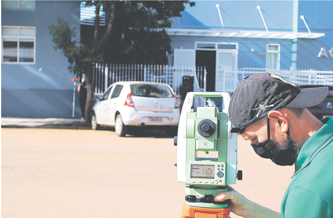
Profissionais fazem a aferição da cota atingida pela cheia na parede da Acil
