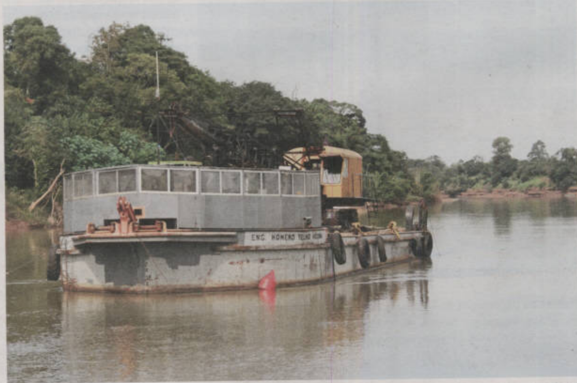
Trabalho de dragagem garante a navegabilidade do rio em trechos com acúmulo de cascalho, diz engenheiro da AHSul
