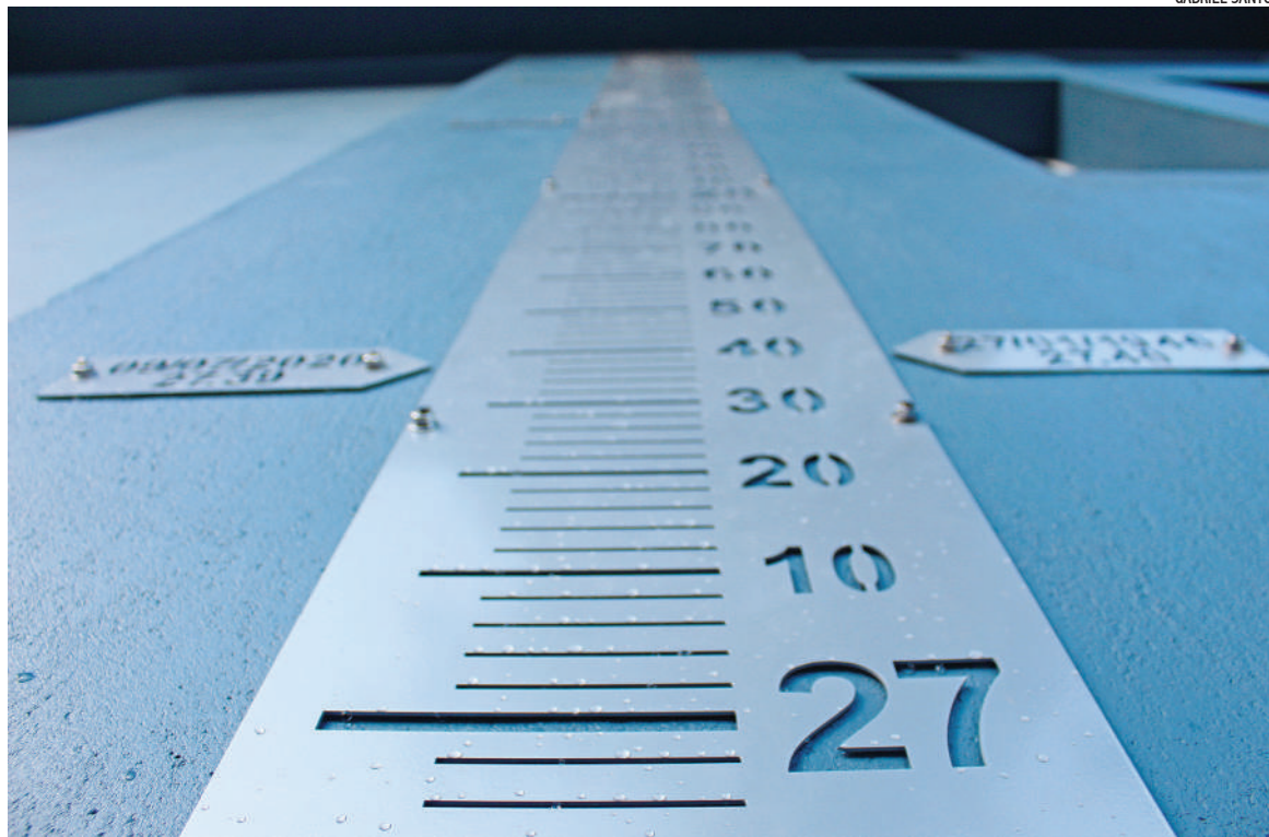
Marcações na sede da entidade apontam registros de enchentes históricas em Lajeado
